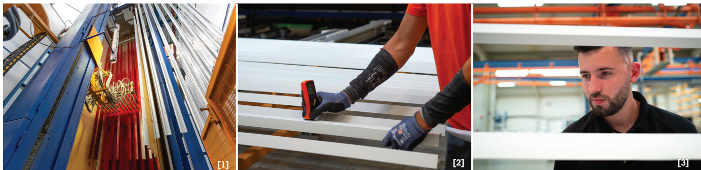
[1] Cabine de poudrage (Reinal). [2] Mesure d'épaisseur du feuil (HBS France Courmelles). [3] Contrôle visuel (Nord Alu Laquage).
